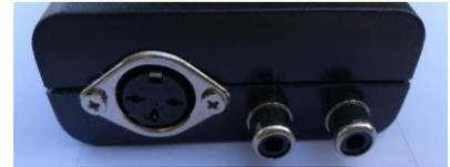
Prise DIN Sonde / Sortie RCA Résistances
