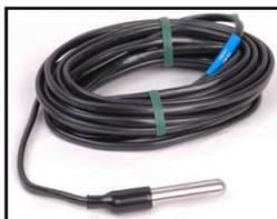
La **sonde de température (st)** située dans la partie haute de la mini-serre permet de mesurer la température à l'intérieur.
