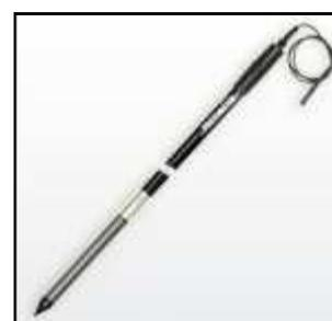
La **sonde d'humidité** (sh) située à mi-hauteur dans la mini-serre permet de mesurer l'hygrométrie à l'intérieur.
