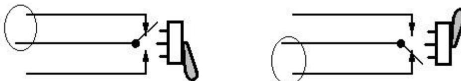
Exemple d'interrupteur : l'inverseur simple = toujours une partie "ouverte" et une partie "fermée" (le partie fermée est entourée)
