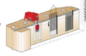
3: Une fois la dalle terminée, on rétablit définitivement la voirie et on termine le tunnel à l'abri de la dalle sans gêner la circulation.
