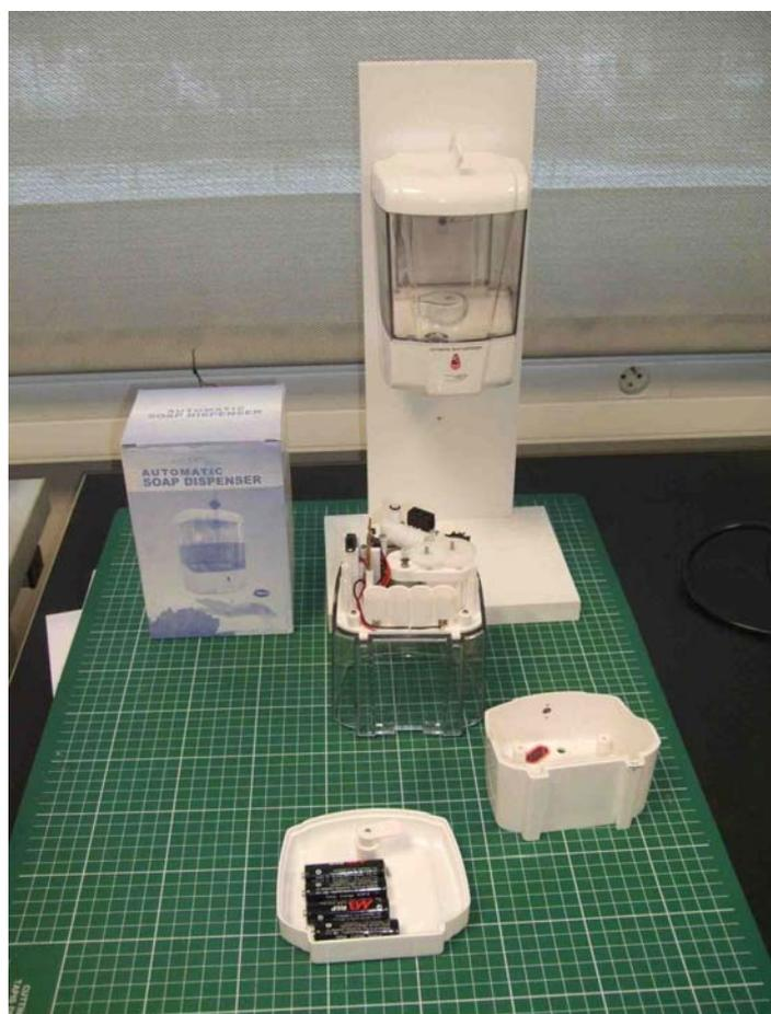
Modification la partie commande en analysant, comprenant et modifiant le programme chargé initialement dans le microcontrôleur PICAXE (monté au préalable) par l'intermédiaire du logiciel « PICAXE programming editor » en suivant le principe :
