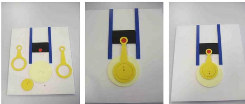
D'autres groupes préfèrent travailler directement sur le distributeur et usiner, sur la fraiseuse à commande numérique, une bielle plus courte pour valider ou invalider la même hypothèse :
