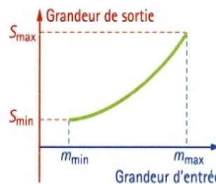
▲ Caractéristique de transfert d'un capteur analogique.
