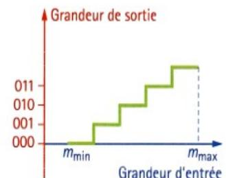
▲ Caractéristique de transfert d'un capteur numérique.
