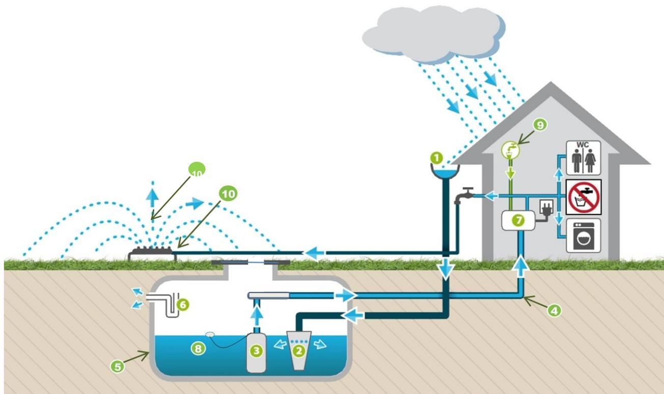
Figure 1 : installation technique de récupération et de distribution d'eau de pluie. Source : [www.tendance-travaux.fr](http://www.tendance-travaux.fr)
