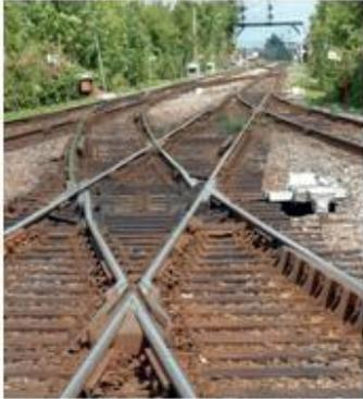
Exemple : le cœur d'aiguillage des chemins de fer est heurté avec violence par les roues des trains. Il doit être très dur et résistant aux chocs. On utilise des aciers spéciaux composés de différents métaux (fer, nickel...) car ils possèdent des caractéristiques exceptionnelles dans ce domaine.
