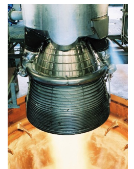
Moteur Vulcain 2 de la fusée Ariane intégrant du titane
