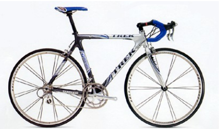
Un cadre de vélo en CFRP pesant seulement 1,08 kg
