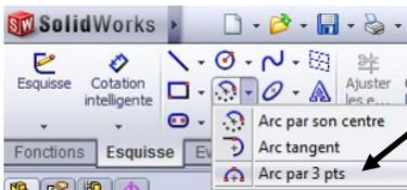
1/ Dans l'onglet « esquisse », sélectionner Arc par 3 points
